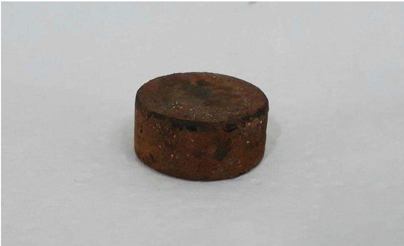
Figura 73 - Compósito Cz-10Fe após aplicação e cessamento de percolação de líquido.
