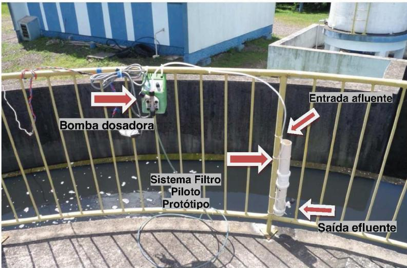
Figura 69 - Protótipo do FBP em operação.
