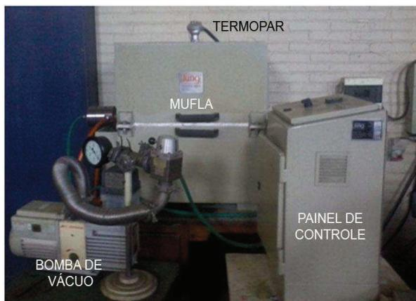
Figura 20 - Forno utilizado na sinterização
