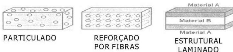
Figura 11 - Classificação dos materiais compósitos segundo sua fase dispersa: particulado, reforçado por fibras e estrutural laminado [57].
