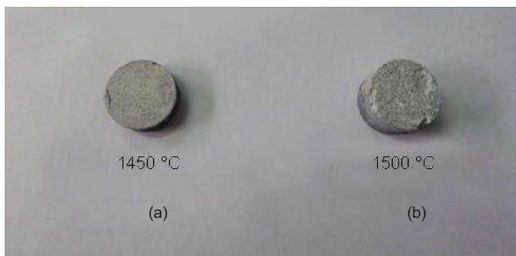
Figura 34 - Amostras  $\text{Al}_2\text{O}_3$ -10Fe sinterizadas a 1450 °C (a) e 1500 °C(b)
